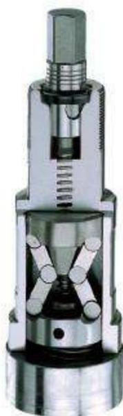
Запатентованный **МУЛЬТИПЛИКАТОР УСИЛИЯ**, выполненный из **ВЫСОКОКАЧЕСТВЕННОЙ ПОДШИПНИКОВОЙ СТАЛИ**, обеспечивает крайне высокое усилие зажима. Давление является более постоянным и это устраняет все проблемы с утечками и проблемы технического обслуживания, связанные с Гидравлическими Тисками.
