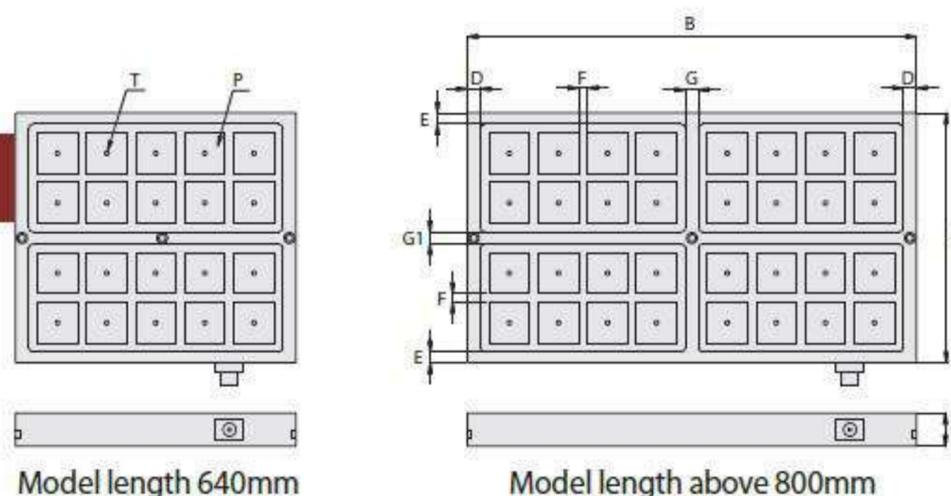
**СПЕЦИФИКАЦИЯ** Размеры магнитного полюса: 91x91mm, Магнитная сила:  $4800 \pm 5\%$  кгс /  $338 \text{ см}^2$  (4 ПОЛЮСА)
