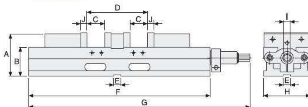
**Спецификация** (Материал: Чугун с шаровидным графитом FCD55. Твердость 50 HRC)
