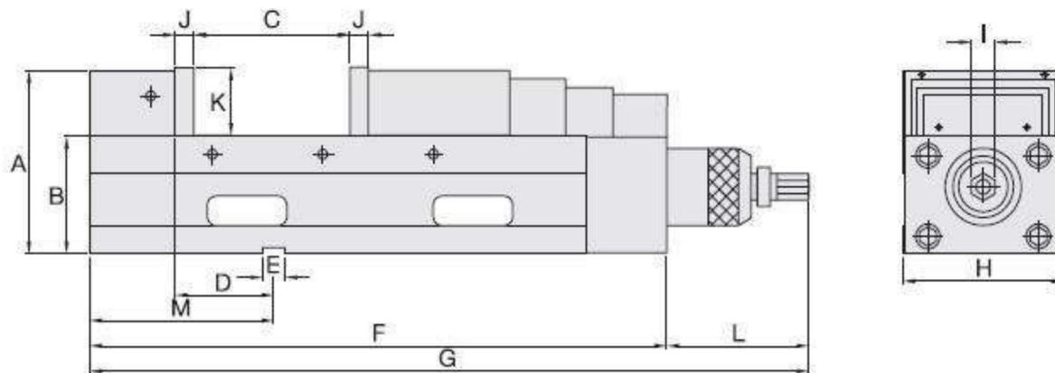
**Спецификация** (Материал: Чугун с шаровидным графитом FCD60, Твердость 50 HRC)
