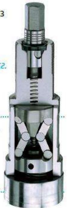
**6.** **Регулировочное стопорное кольцо:** Данное простое и эффективное устройство предварительной настройки **позволяет предварительно установить любое необходимое прижимное усилие** и гарантирует повторение каждой зажимной операции при одинаковом прижимном усилии.
