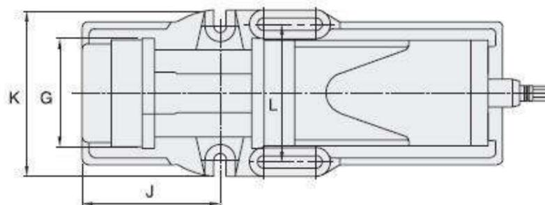
**Спецификация** (Материал: Чугун с шаровидным графитом FCD60. Твердость 50 HRC)
