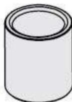
СПЕЦИФИКАЦИЯ (Материал: SNCM8. Твердость 40-45 HRC. Отделка: черный оксид) Ед. измерения: мм
