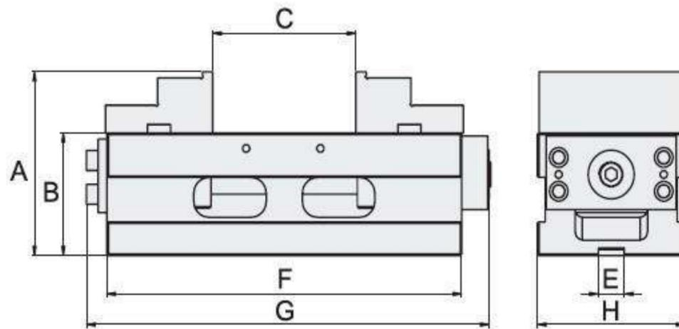
**Спецификация** (Материал: Чугун с шаровидным графитом FCD 60, твердость 50 HRC / Материал мягких губок: стали)
