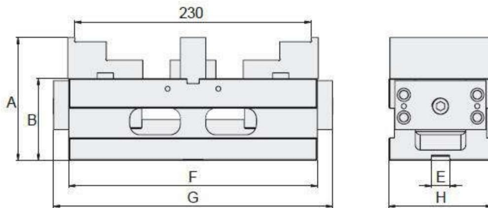
Спецификация (Материал: Чугун с шаровидным графитом FCD 60, твердость 50 HRC / Материал мягких губок: стали)
