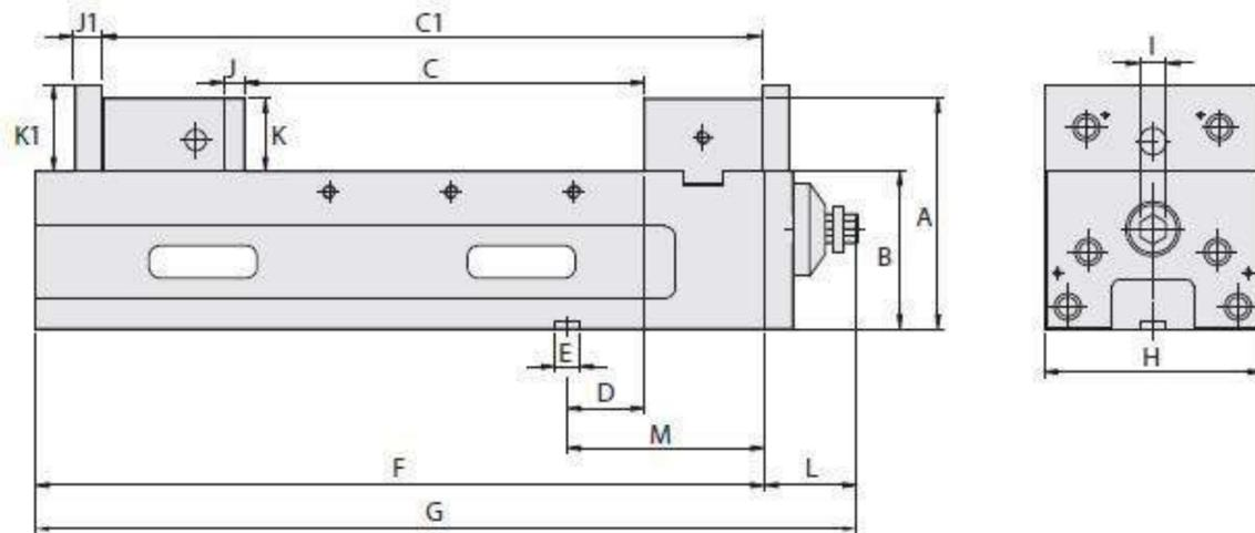
**Спецификация** (Материал: Чугун с шаровидным графитом FCD60. Твердость 50 HRC)
