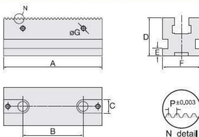
**СПЕЦИФИКАЦИЯ** (Материал: Инструментальная сталь. Твердость: свыше 56~60 HRC)
