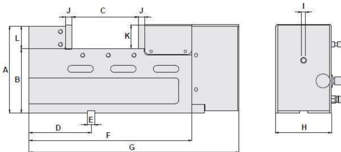
**Спецификация** (Материал: Чугун с шаровидным графитом FCD60, твердость 50 HRC)
