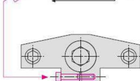
Если допуск обрабатываемой детали больше, чем 5мм, пожалуйста, отрегулируйте этот винт.
