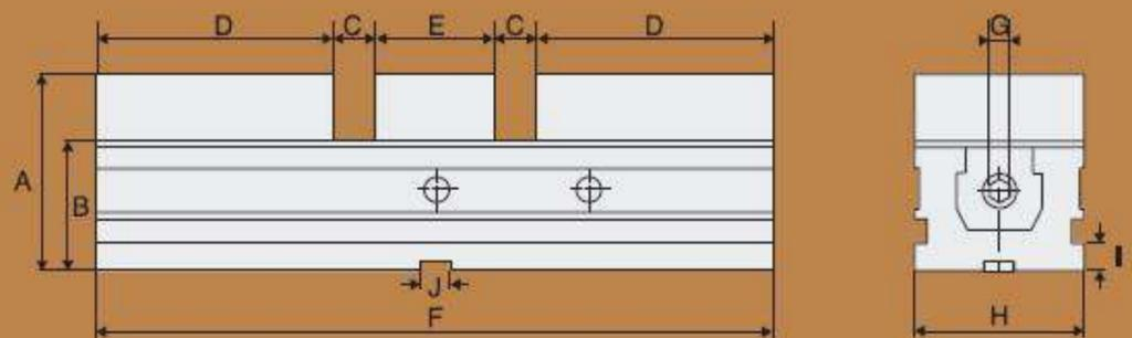
**Спецификация** (Материал: алюминиевый сплав, устойчивый жесткий анодированный корпус тисков)
