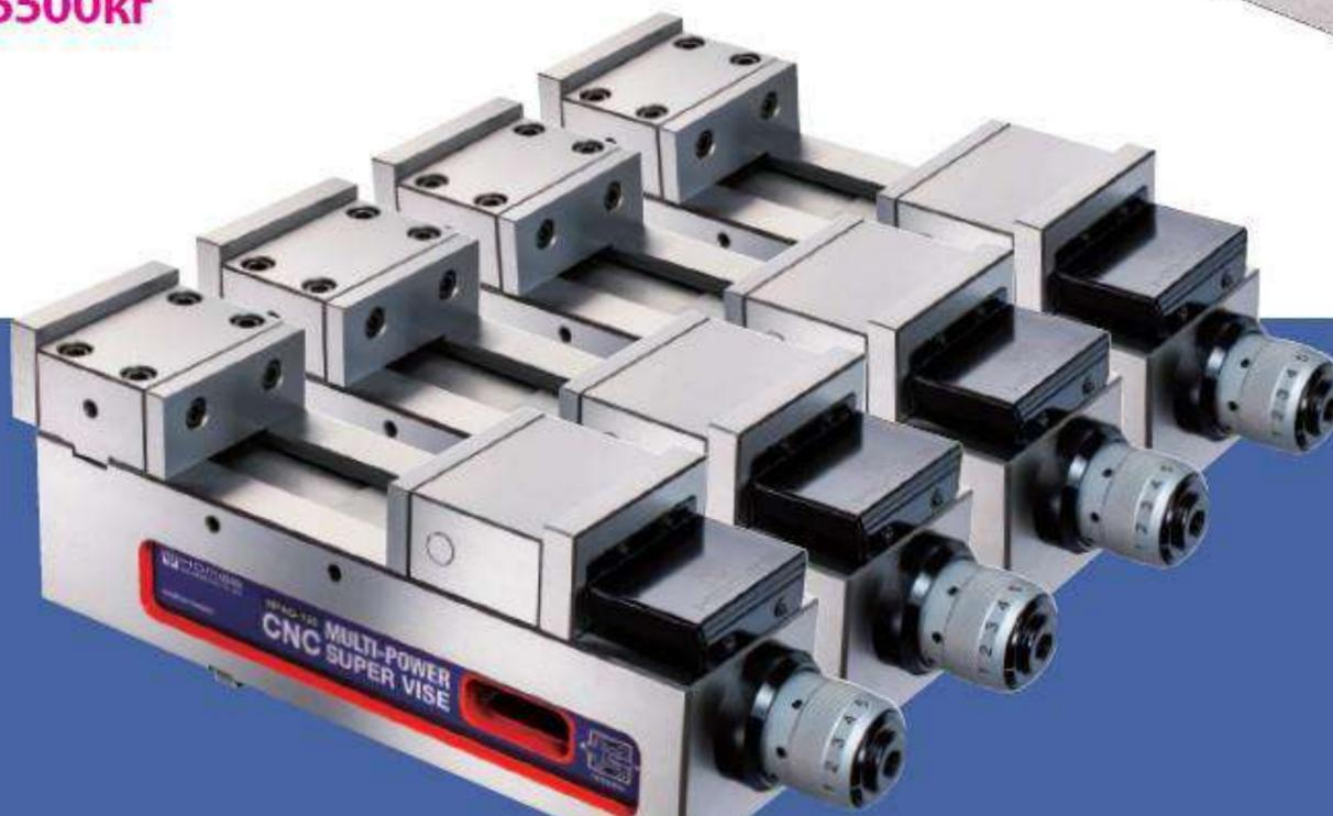
**1.** Тиски с неподвижными губками выполнены из высококачественной стали и **ЗАКАЛЕНЫ** до твердости **HRC 55**. Корпус тисков выполнен из чугуна с шаровидным графитом марки FCD 60 для высокой точности и износостойкости. При силе 2500кг, образец прогнется менее чем на **0.005мм**.
