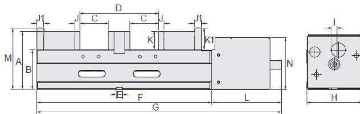
**Спецификация** (Материал: Чугун с шаровидным графитом FCD 60, твердость 50 HRC )
