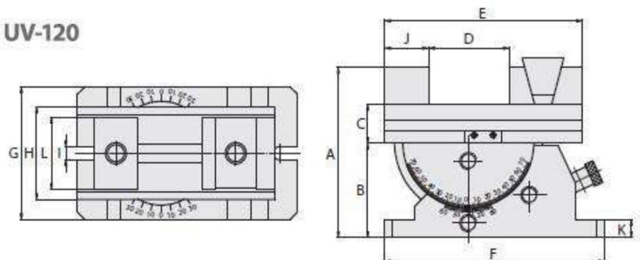
**Спецификация** (Материал: Тиски: Сталь / Основа: Высокопрочный чугун FCD50)
