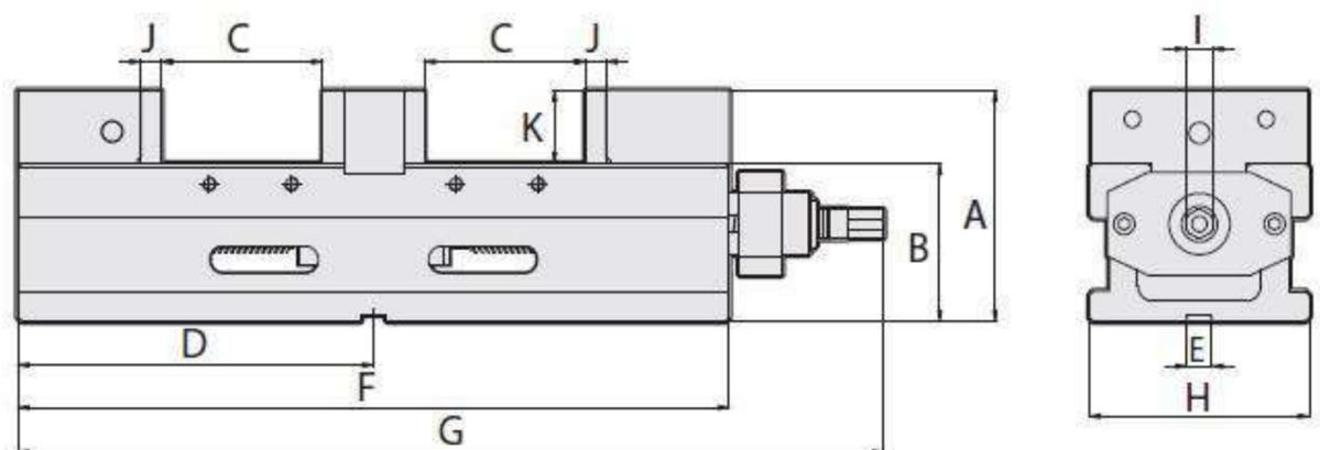
**Спецификация** ( Материал: Чугун с шаровидным графитом FCD60, Твердость 50 HRC )
