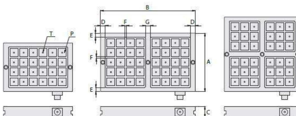
**СПЕЦИФИКАЦИЯ** Размеры магнитного полюса: 70x70mm, Магнитная сила:  $2800 \pm 5\%$  кгс /  $196 \text{ см}^2$  (4 ПОЛЮСА)
