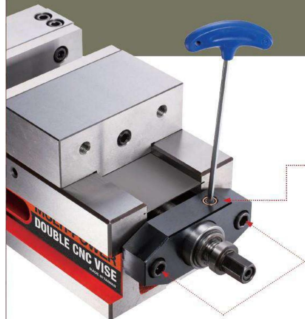
Если допуск обрабатываемой детали больше, чем **5мм**, пожалуйста, отрегулируйте этот винт.
