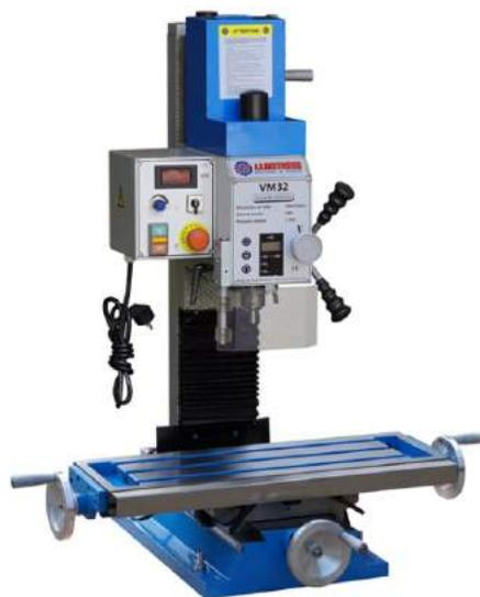
Сверлильно-фрезерный станок VM32L предназначен для обработки небольших и лёгких деталей из различных материалов в условиях мелкосерийного производства. Питание от сети 220В и малые габариты позволяют использовать станок в домашней мастерской.
